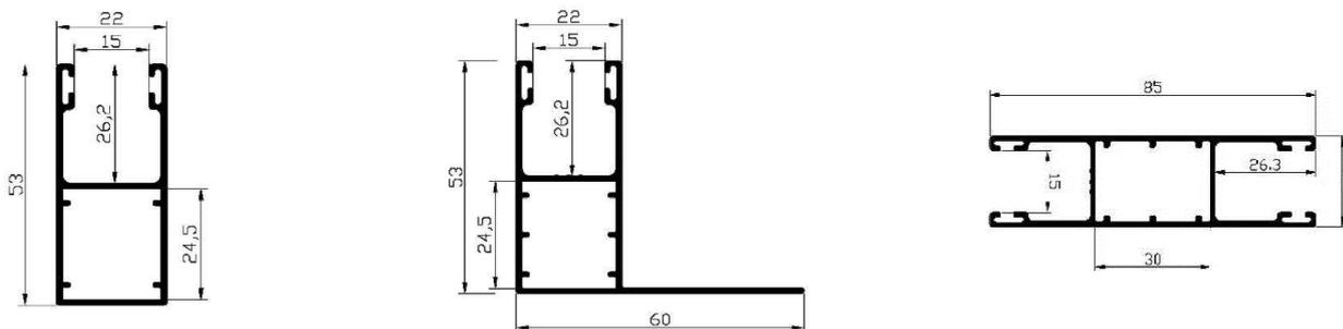
**A3 (Standard-Führungsschiene)    A4 (Rechtsroller-Führungsschiene)    DF3 (Doppel-Führungsschiene)**
