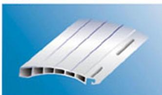
Mini-Rolladenprofil, sehr engwickelnd für nachträglichen Einbau und Elementbau. Lieferbar als Stabware (gelocht/ungelocht) oder als Fertigpanzer – Klammerarretierung gegen Aufpreis.
