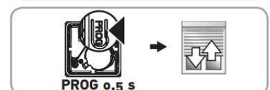
**Nach Abschluss der Endlagenprogrammierung unbedingt 2 vollständige Fahrzyklen ausführen, damit der Motor die Drehrichtung erkennt und die Endlagen abspeichert!**
