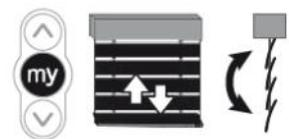
> Durch kurze Druckimpulse auf die AUF-Taste des Somfy io-Funksenders lassen sich die Lamellen von der Position Lamellen geschlossen bis zur Position Lamellen vollständig geöffnet bewegen.
